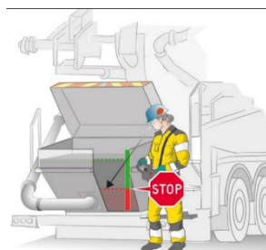
Kontrollera regelbundet nivån i mottagningsfickan. Obs! Ha aldrig huvudet eller andra kroppsdelar över mottagningsfickan. Plattformen får ej beträddas under lossning till pump.
